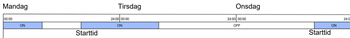
Figur 13: Hvis en ON-tid løber over midnat på et døgn, hvor uret ikke er aktivt, vil funktionen forblive ON, indtil tiden er udløbet.
